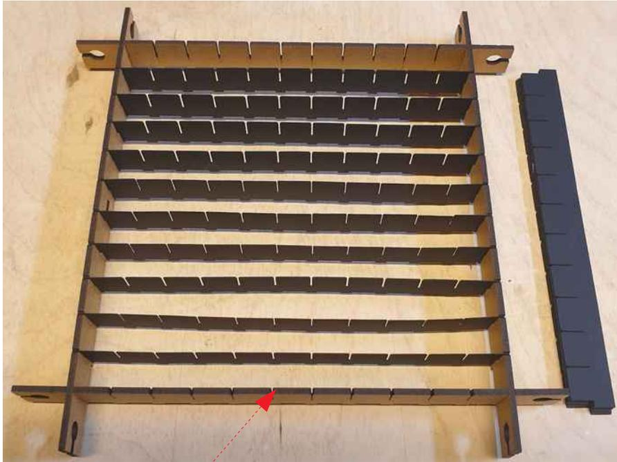
Schlitz ggf. mit dem Cutter aufweiten
