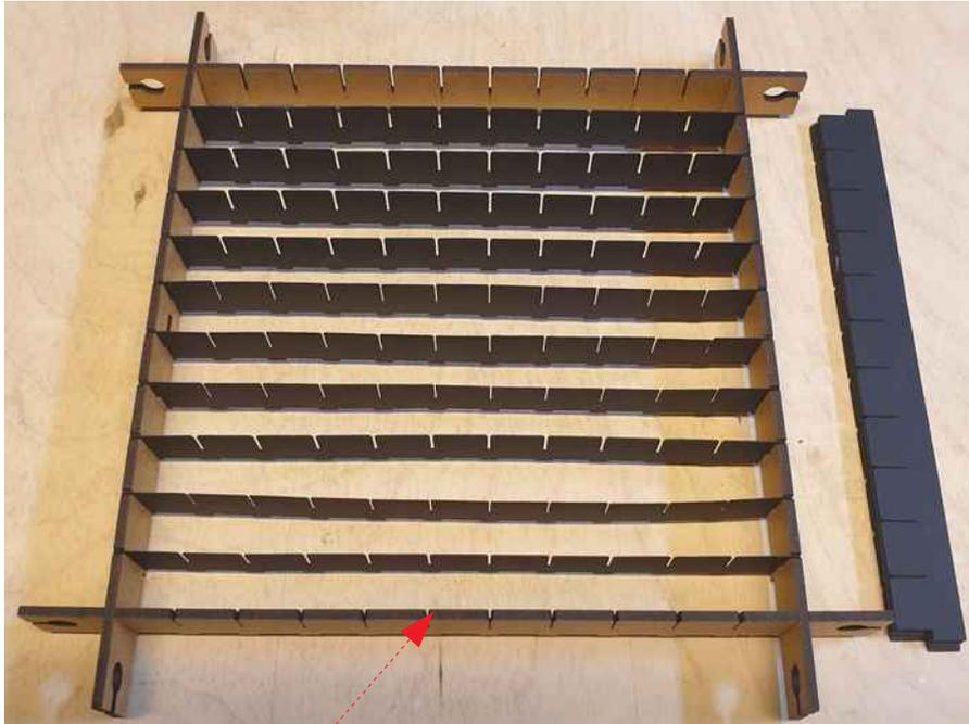
Schlitze ggf. mit dem Cutter aufweiten
