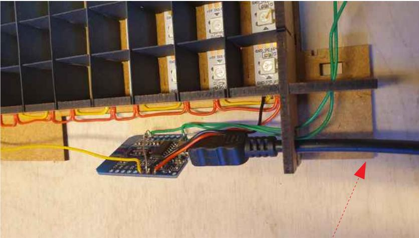
Mit den Cutter die Ecke für den Leitungsdurchgang herstellen.
