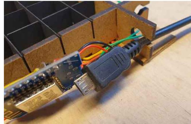
Mit den Cutter den Ausschnitt auf den Leitungsdurchmesser vergrößern.
