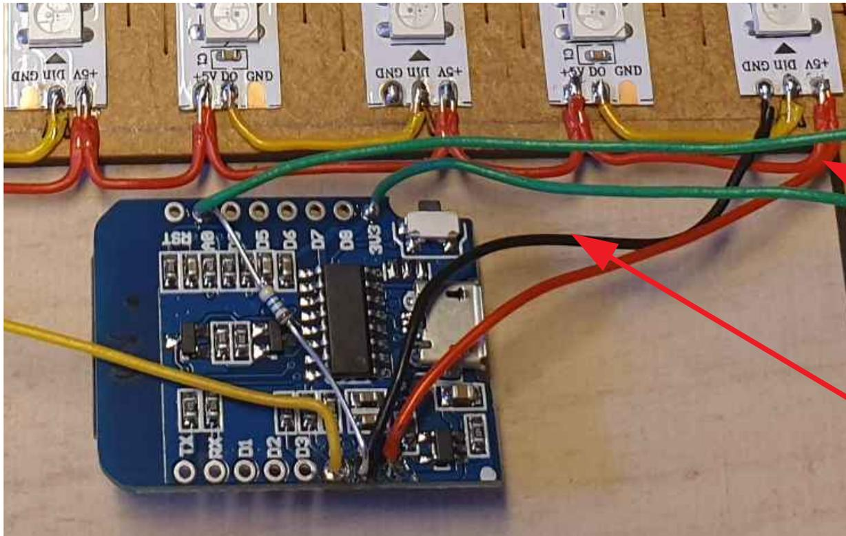
Rote Leitung von ESP 5V mit LED-Streifen +5V Zusammen mit der weiteren roten Leitung verbinden.
